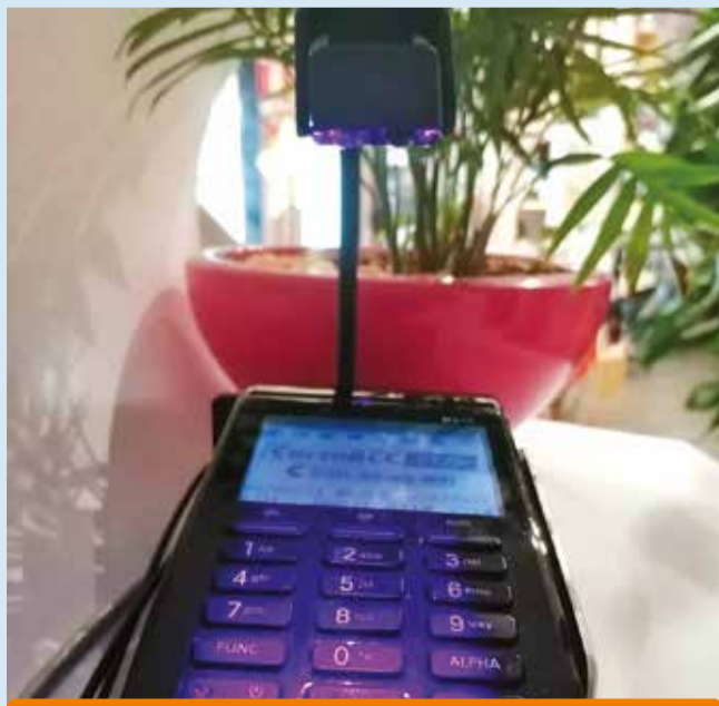
Geronimo, il dispositivo a luce ultravioletta (UV-C) per sanificare i bancomat
